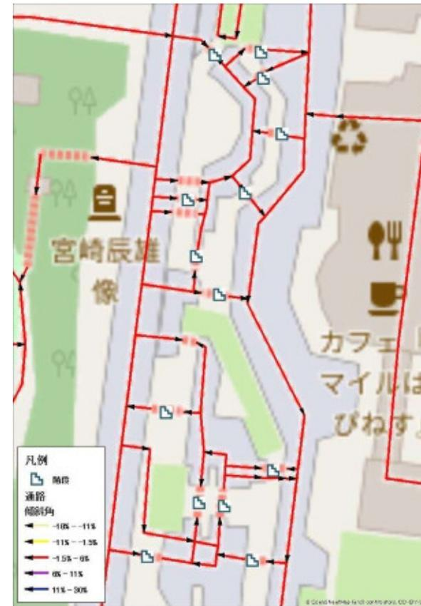
「傾斜角度」と「階段」の位置を可視化
